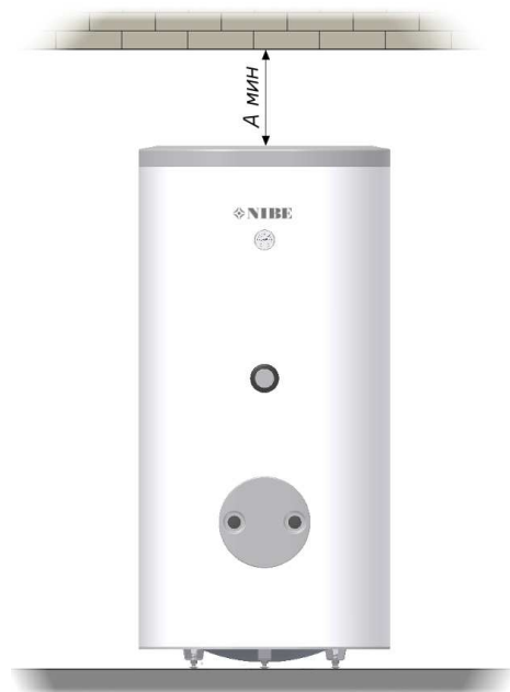
Рис. 3 Минимальное расстояние для замены защитного магниевого анода.
